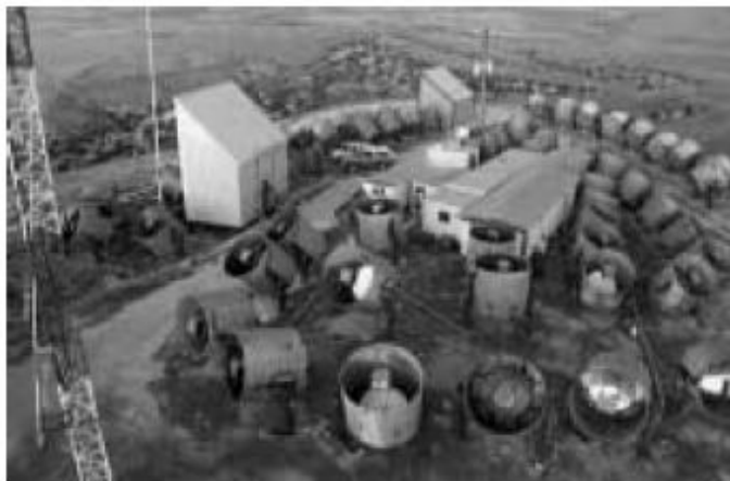
2. ábra. A Légyszem (Fly's Eye) kozmikus sugárzási detektortelep. A jól megkülönböztethető tartályokban haladó töltött részecskék keltette Cserenkov-sugárzás révén mérik a zápor részecskéinek sebességét, amelyből számított mozgási energia segítségével számolják vissza a záport indító kozmikus részecske energiáját.
