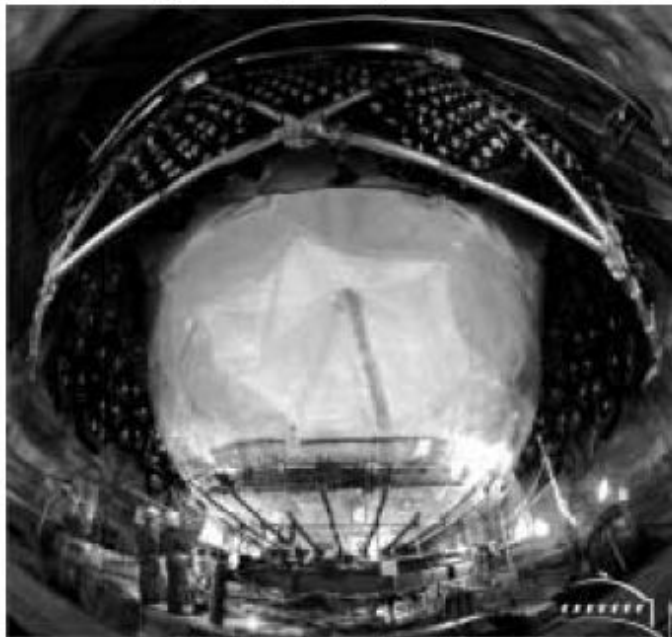
4. ábra. A Sudbury Neutrino Observatory (Kanada) 1000 t nehézvízzel feltöltött tartálya, amelyben a Napból érkező neutrínók bármely fajtája reakciót vált ki, így lehetőség van a teljes neutrínófluxus észlelésére.
