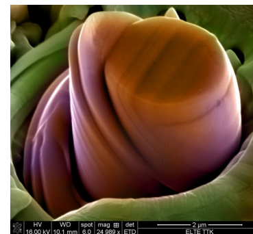
Réz egykristályból kialakított mikro-oszlop (micropillar)
