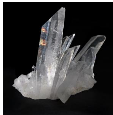
Kvarc: hatszöges \text{SiO}_2 kristály
