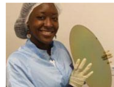
\text{SiO}_2 bevonatú, 450mm átmérőjű Si szelet
