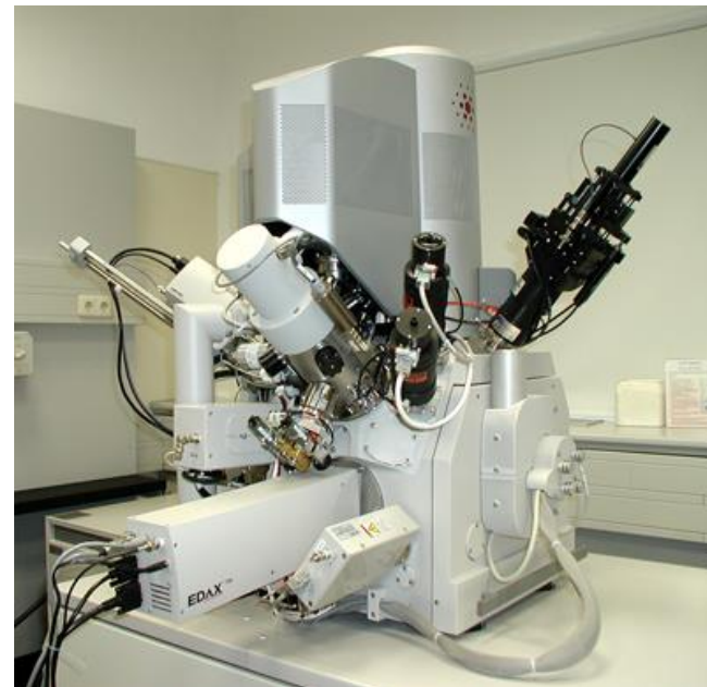
FEI Quanta 3D típusú, nagyfelbontású, kétsugaras készülék
