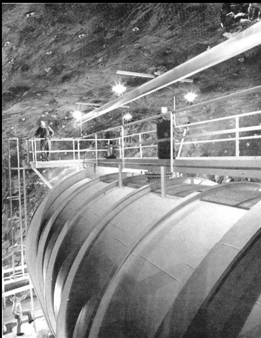
Homestake ( ^{37}\text{Cl} neutrínó detektor)
